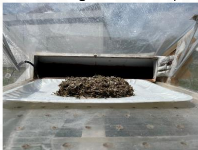
Figura 4. Vista interior de la cámara de secado
